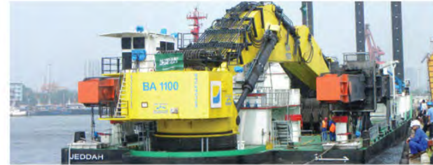
船型：反铲式挖泥船 船级社：CCS 船厂：天津中交博迈科船舶重工有限公司 船东：天津中交航道局
